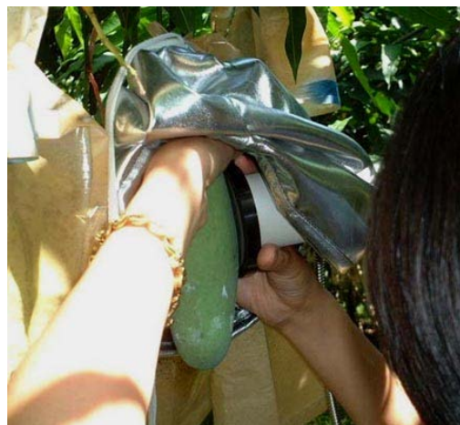
ハンディタイプ分光器による樹上での マンゴの測定
