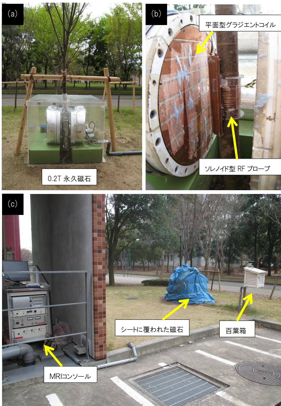
図1 屋外樹木用コンパクトMRIシステム (a) 0.2T 永久磁石、(b) 平面型グラジエントコイルとソレノイド型 RF プローブ (c) MRI システムの全体図
