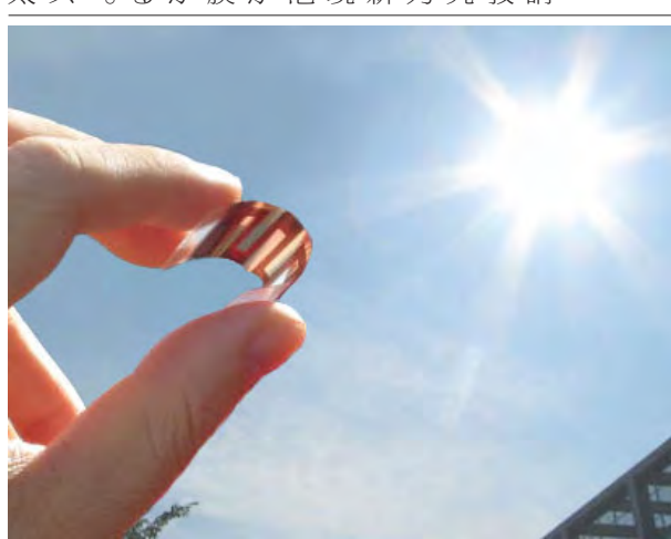
新しい製造法で開発した有機薄膜太陽電池のサンプル
