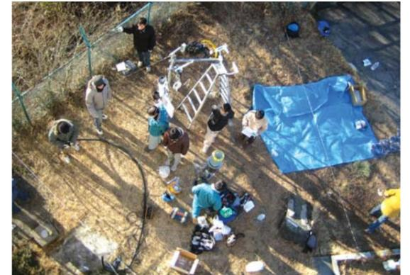
写真3 気象観測ステーション敷地内における測定機器の設置状況
