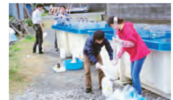
図5 培養器からはチューブ状の容器を用いて、鉛直的に積算する方式で試水を採取する。
