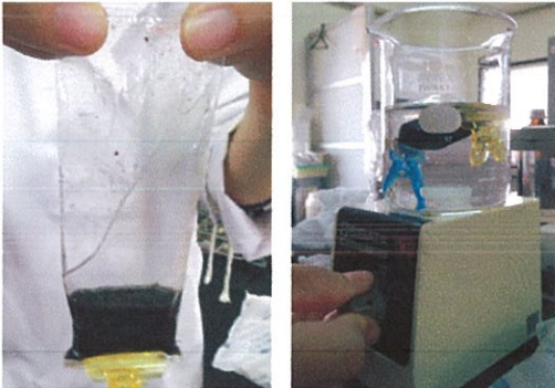
上段左から: 図10-1 綿棒で菌体をこすり取る・図10-2 ゆるい遠心分離後 図10-3 上澄み液に硫酸アンモニウムを投入・図10-4 上澄み液を捨てた木の 白カビと緑カビ・図10-5 透析膜に入れたニガー・図10-9 スターラーで攪拌中
