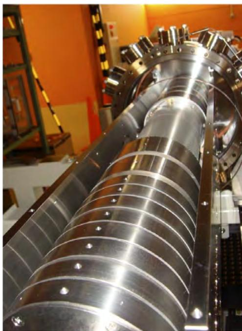
**図3 実験装置概念図および MRTOF 飛行部の写真**
