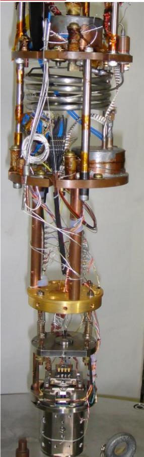
図1 本研究で開発した円偏光近接場光学顕微鏡。
