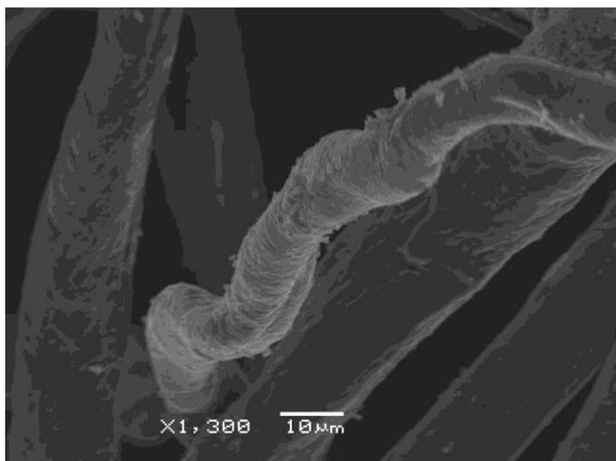
図1. 綿の上に合成したポリアニリン(複合体)の走査型電子顕微鏡写真
