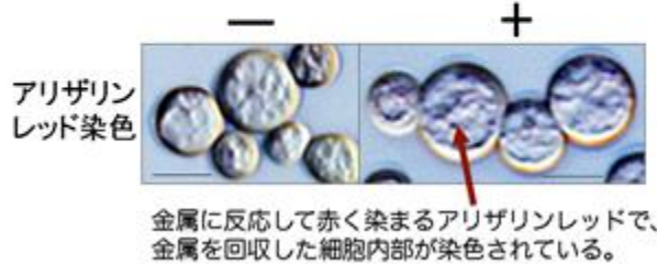
図 4. 準嫌気従属栄養条件⑤で、レアアースと銅を回収した細胞のアリザリンレッド染色 アリザリンレッド溶液に浸漬して染色し、表面洗浄を行った後、位相差顕微鏡で観察
