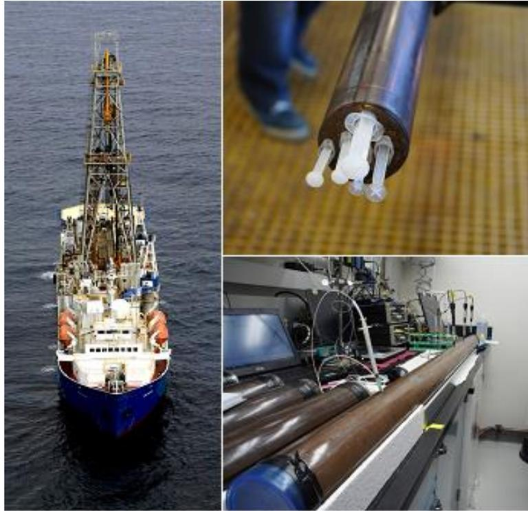
図2. 掘削船ジョイデス・レゾリューション号（左）と IODP 第 329 次研究航海における微生物分析試料を採取する様子（右上）。船上に回収されたコア試料は、約 4℃に設定された船内の冷蔵実験室に運ばれ、センサーによる溶存酸素濃度の測定が行われた（右下）。
