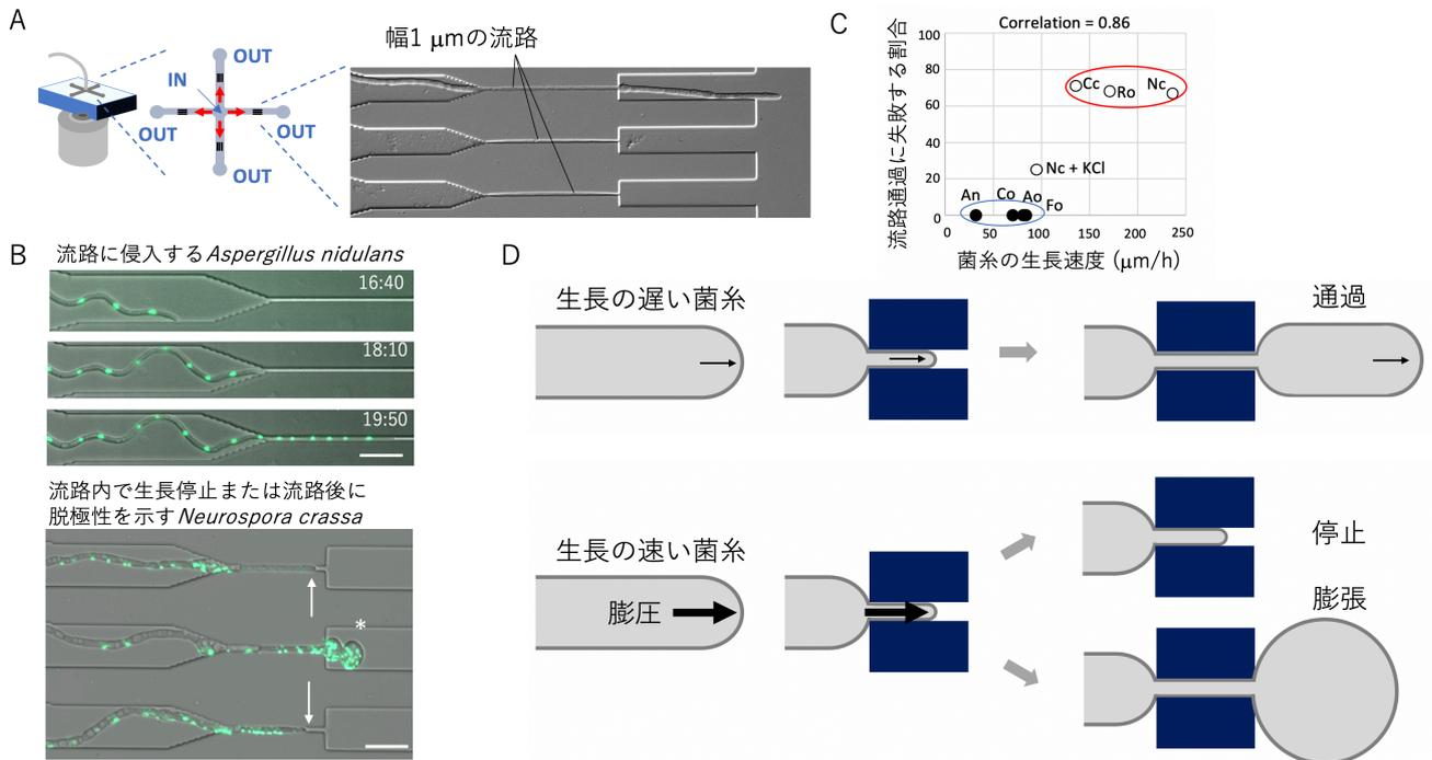
(A) 本研究で使用したマイクロ流体デバイスの概略図。(B) 流路内に侵入するモデル糸状菌 *Aspergillus nidulans* の菌糸 (核を GFP で標識) と、流路内で生長停止 (矢印) または流路通過後に菌糸の膨張 (\*) を示す *Neurospora crassa* (アカパンカビ) の菌糸。スケールバーは 20 μm。(C) 異なる系統の 7 種の糸状菌における、流路通過に失敗する菌糸の割合と菌糸の生長速度の相関関係。(D) 細胞形態の変異性と生長速度の間のトレードオフの概要。生長の遅い菌糸は膨圧が低く、微小空間を通過するのに対し、生長の速い菌糸は膨圧が高く、微小空間の途中で停止するか通過した場合には脱極性が生じ形態を維持できない。
