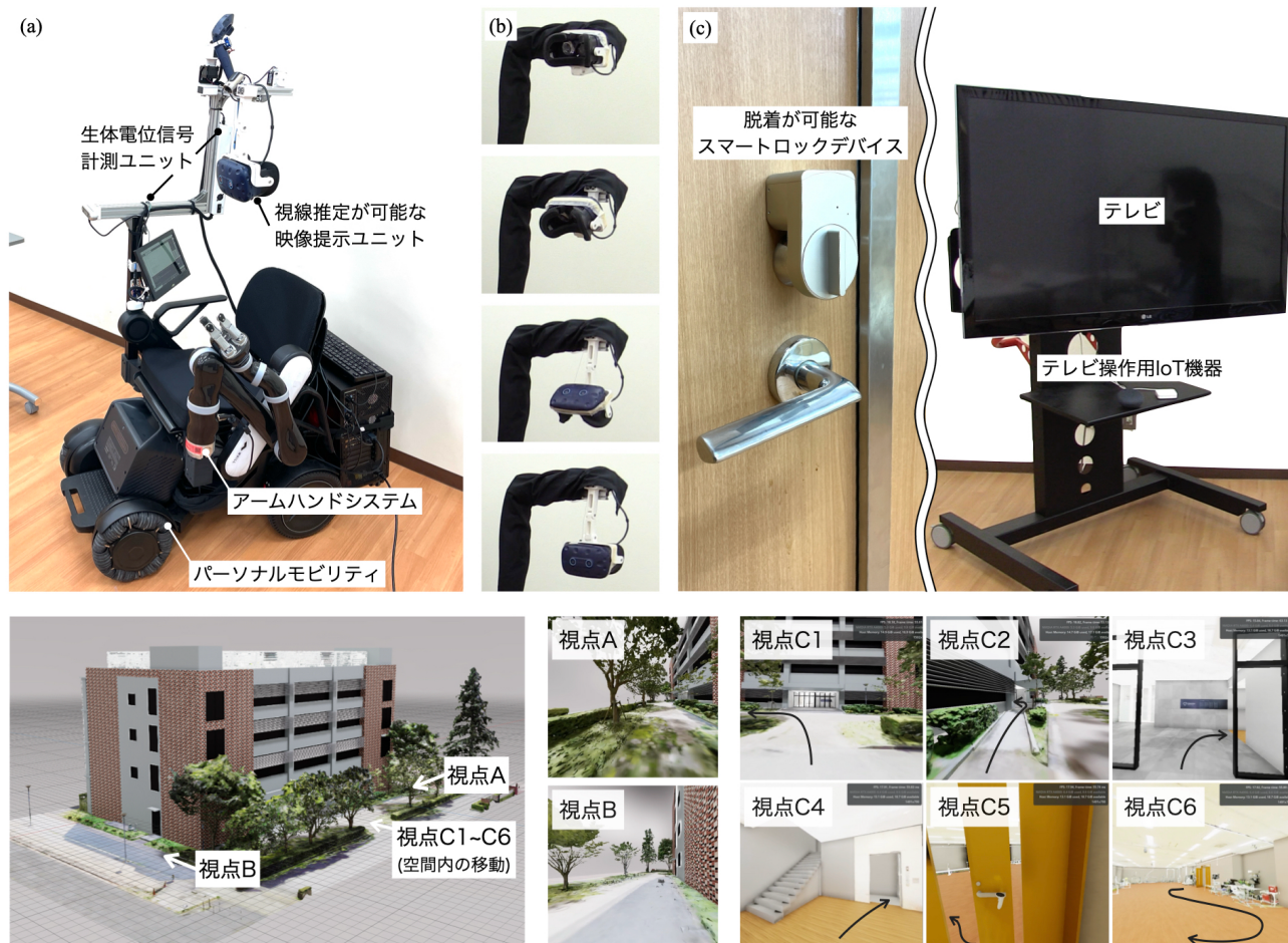
図 本研究で開発された人協調型ロボット（上）および試験で用いたサイバー空間（下）
