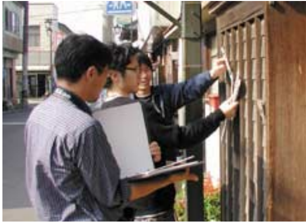
歴史的な家屋の測色調査を行う学生(真壁町の中村家で)
