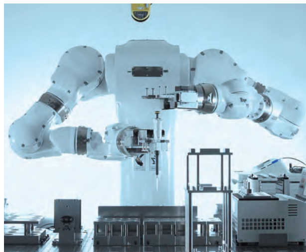
AIロボット「まほろ」による高精度のゲノム解析
